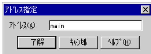
図 36 [アドレス指定]ダイアログボックスでアドレスを_main シンボル値に指定
