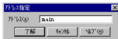
図 34 [アドレス指定]ダイアログボックスでアドレスを_main シンボル値に指定
